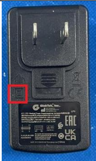
II類結構符號 刻在設備本體上
